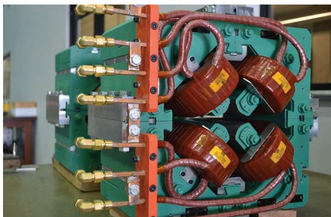
Figura 24 - Protótipo do quadrupolo desenvolvido pela WEG.
