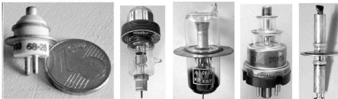
Da esquerda para a direita: *Cermet*, *micropup*, *rocket*, *lighthouse* e *pencil* (ASE, 2019, Vacuum tube list, T05).
