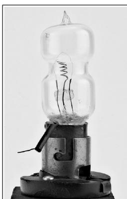
Válvula *peanut* WT501 (triodo sem grade): criada em 1923, foi uma tentativa de contornar a patente de Forest, pondo a grade fora do envoltório (um fio que era enrolado na parte estreita do bulbo). Media 62 mm x 19 mm; a voltagem do filamento era de 4 a 6 V e a da placa, de 16 a 22,5V; o consumo era de até meio ampère (WELSH, 2019).
