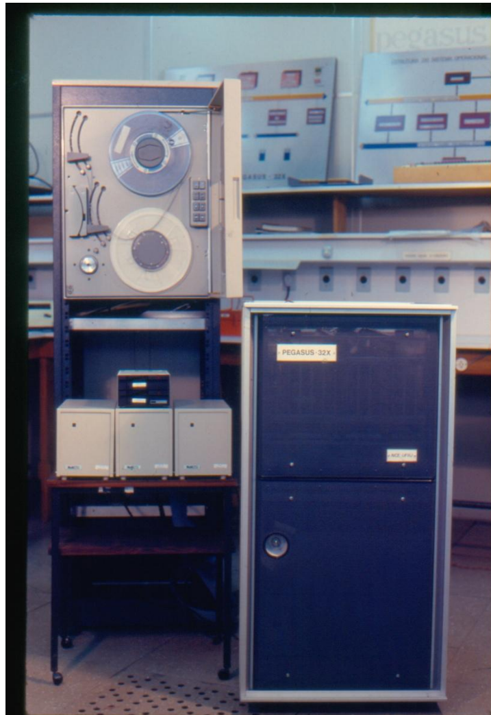
Figura 13: O computador Pegasus 32X desenvolvido no NCE (Fonte: acervo do NCE).
