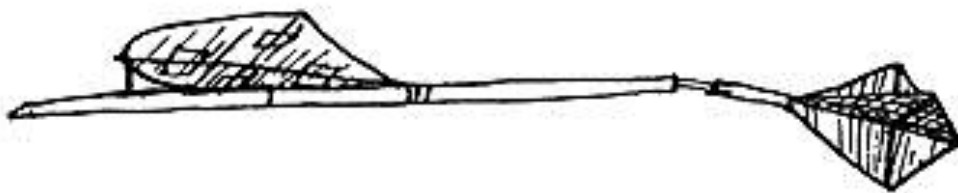
Figura 5.12 - Esboço por George Cayley do seu modelo de Planador Monoplano (1804). Fonte: disponível em < http://www.flyingmachines.org/cayl.html >. Acesso em 05/09/2011.
