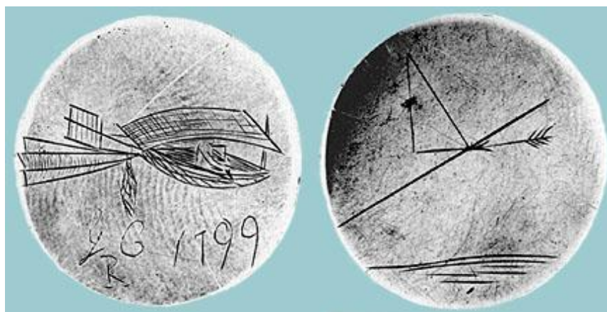
Figura 5.10 - O Medalhão Cayley e suas duas faces, representando, à esquerda, um monoplano planador com linhas de “flappers” sob as asas para o impulso e, à direita, as forças de sustentação e arrasto (1799). Atualmente no British Science Museum.
