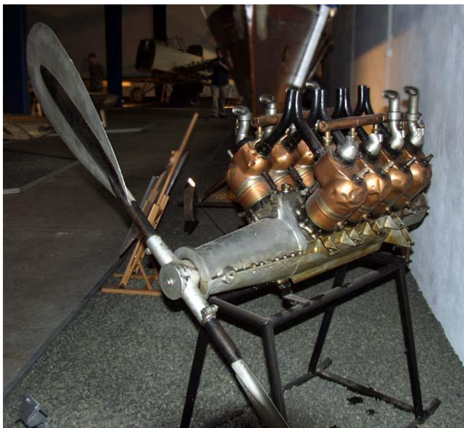
Figura 8.4 - O motor Antoinette V-8, patenteado em 1902, já era bem operacional em 1904. O mostrado acima provavelmente é de 1909.
