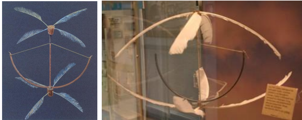
Figura 5.9 - O “helicóptero” de Launoy e Bienvenu (esq.) modificado por Cayley (dir.).
