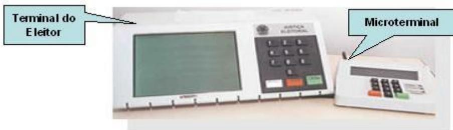
**Conjunto urna eletrônica: microterminal e terminal do eleitor.**<sup>105</sup>
