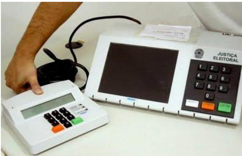
**Urna eletrônica com identificador biométrico do eleitor no microterminal.**<sup>234</sup>
