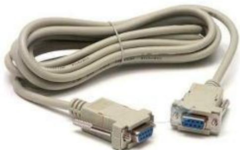
Um cabo que conecta o microterminal ao terminal do eleitor em uma interface serial RS-232C.<sup>108</sup>
