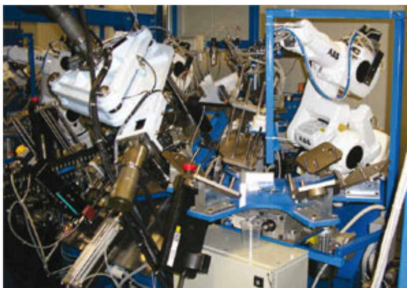
Mecanismo robótico do Ópera para lidar com as emulsões nucleares; nesse experimento, a varredura óptica das emulsões era totalmente automatizada (Crédito: Ópera)
