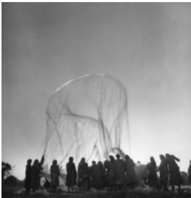
Balões de polietileno desenvolvidos pela equipe do Laboratório H. H. Wills, da Universidade de Bristol, na década de 1950, para voos levando emulsões nucleares (Crédito: Peter Fowler)
