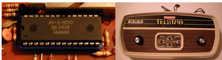
Figura 13: À esquerda, um exemplo de Pong-in-a-Chip e a direita, o Coleco Telstar , um dos clones do Home Pong
