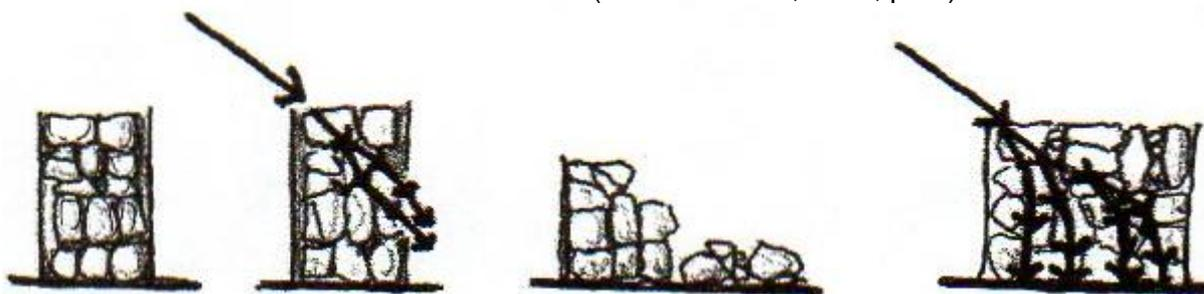
Figura 66 - Largura das paredes autoportantes de pedra.
