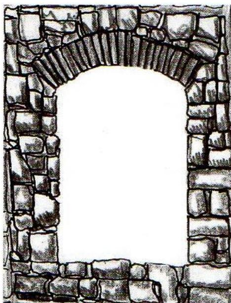
Figura 67 - Desenho demonstrando as paredes autoportantes de pedra com arcos em tijolo maciço.
