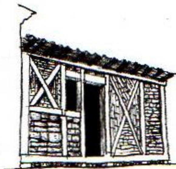
Figura 81 - Exemplo de construção mista, com estrutura autônoma e paredes de vedação de adobe e tijolo.
