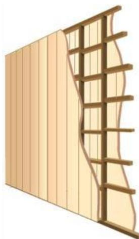
Figura 83 - Desenho exemplificando uma parede interna de estuque.
