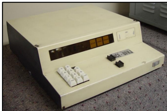
Figura 10 Testador de Circuitos Integrados (Fonte: Acervo ACS/NCE)
