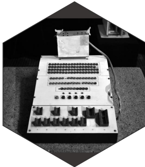
Figura 12 Testador de Circuitos Digitais (Fonte: Acervo ACS/NCE)
