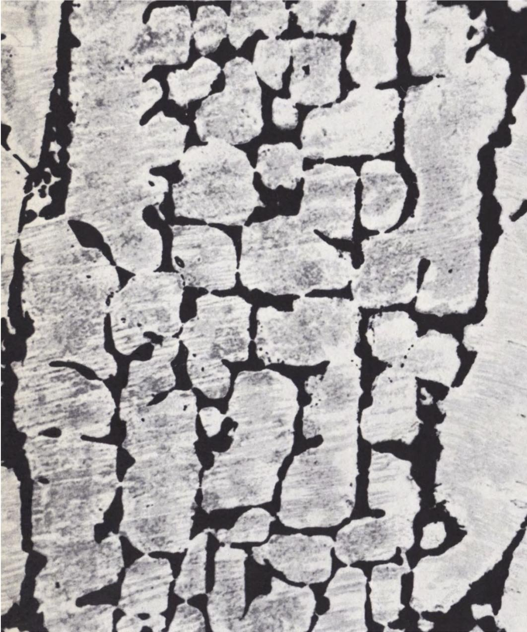
Liga de cobre-alumínio, textura da fundição; lixada e polida, gravada com nitrato férrico. Fotomicrografia, 675:1
