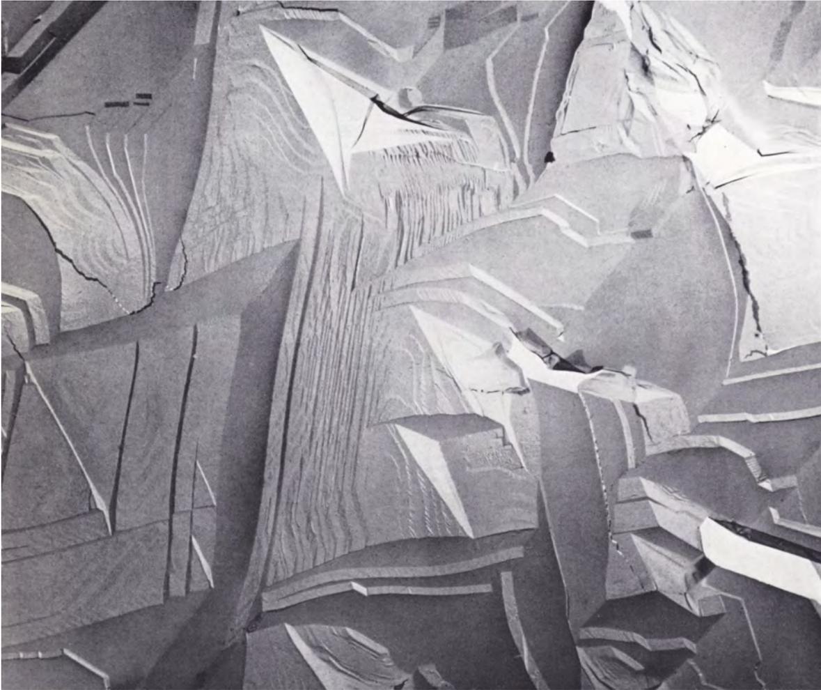
Superfície de cobre oxidada, processo Réplica, filme de carbono.
