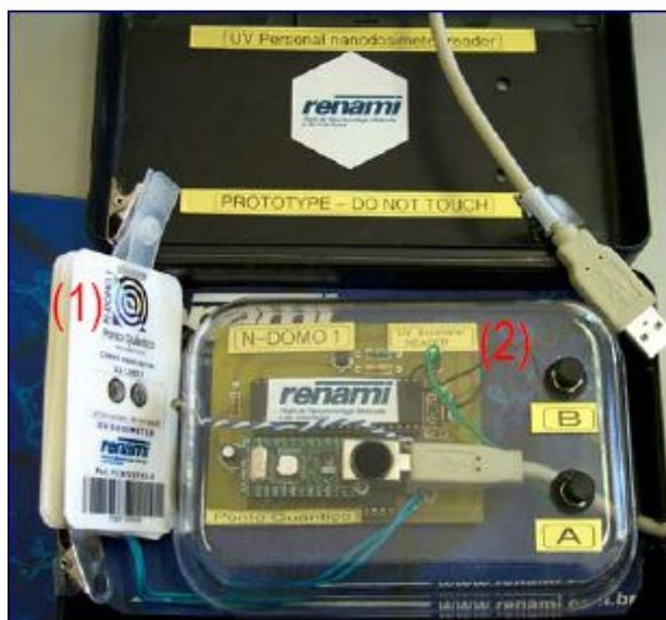
Fig. 2 – Nanodosímetro UV (1) e Leitor USB (2)
